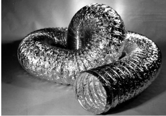
Le flexible **ALUDEC CLASSIC** est réalisé en complexage de plusieurs matériaux et répond à diverses applications. Il est constitué de plusieurs couches d'aluminium et polyester qui renferment une spirale en acier. Les gaines peuvent être raccordées sans problème à des connexions rondes ou ovales.
