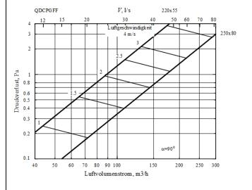
Druckabfall pro Längeneinheit Δp/L für die drei unterschiedlichen Längen des Kanals für Kanal.
