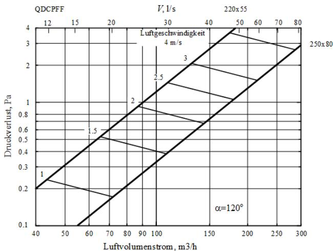
Druckabfall pro Längeneinheit  $\Delta p/L$  für die drei unterschiedlichen Längen des Kanals für Kanal.
